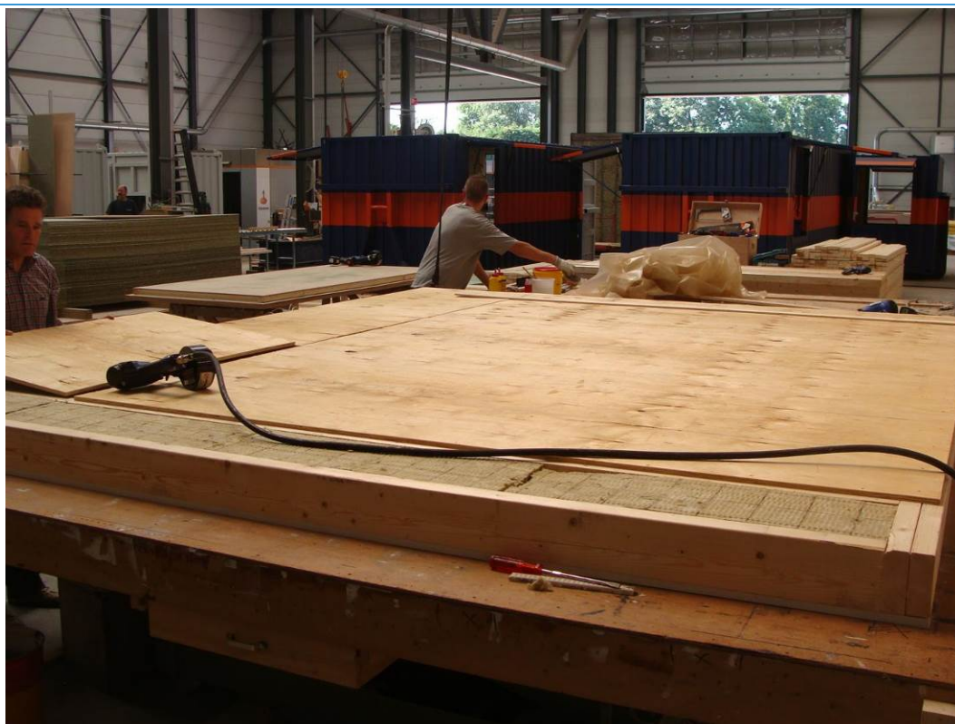
Foto C.5 Bovenzijde vloerconstructie tijdens aanbrengen underlayment
