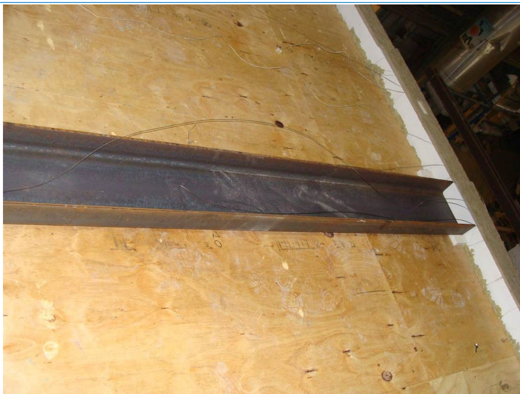
Foto C.7 Bovenzijde vloerconstructie voorzien van stalen U-profiel
