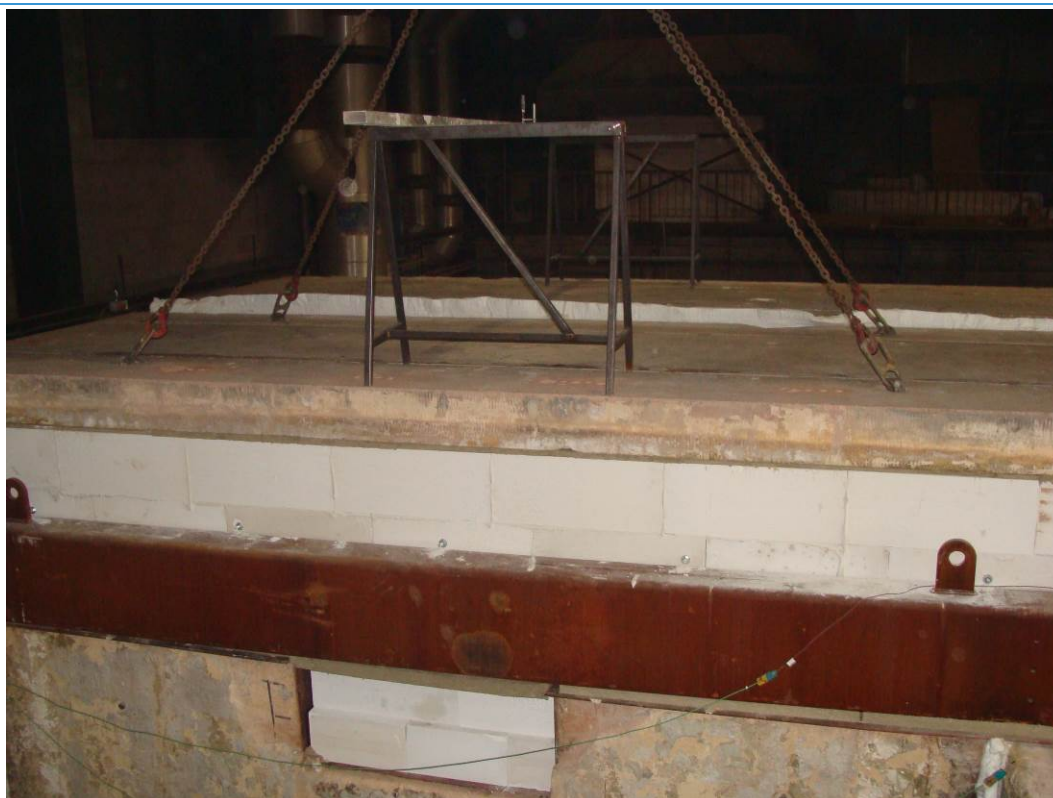
Foto C.8 Proefstuk tijdens de test, aan de bovenzijde voorzien van een betonnen vloer
